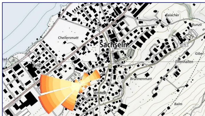
Abbildung 19: Schadstofffrose der Messungen in Sachseln 2019/20 auf der Landeskarte. Südwestlich der Messstelle befindet sich eine Holzschnitzelheizung. Deren negative Einfluss auf die Luftqualität kann nicht ausgeschlossen werden.
